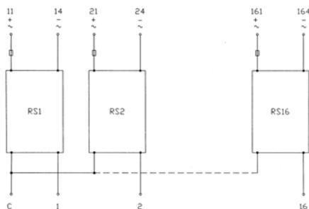
Schema di collegamento Modulo interfaccia a 1 relè statico mod. SSR21-3240B5/mod. SSR21-3240B e mod. SSR20-524B5/ mod. SSR20-524B.
